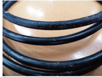
图3 O型圈上附着的砂性颗粒
